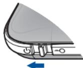
Cuando el dispositivo entre en modo de suspensión, la Wi-Fi será desactivada y la conexión de datos móviles será desconectada. Para que un dispositivo entre en modo de suspensión, asegúrese de que la pantalla OLED esté encendida, deslice el botón de encendido hacia el icono WPS (🔌) y suéltelo. Para devolver al dispositivo a su modo normal, encienda la pantalla OLED, deslice el botón de encendido hacia el icono WPS (🔌) y suéltelo.
