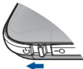
Quando il dispositivo è in modalità Sleep, il Wi-Fi sarà disabilitato e la connessione dati mobile verrà disconnessa. Per porre il dispositivo in modalità Sleep, accertarsi che lo schermo OLED sia acceso, far scorrere l'interruttore di alimentazione verso l'icona WPS (🔌) e rilasciarlo subito.
