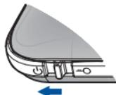
Kun laite on lepotilassa, Wi-Fi on pois käytöstä ja mobiili tietoliikenneyhteys on katkaistu. Kun asetat laitteen lepotilaan varmista ensin, että OLED-näyttö on päällä, liu'uta virtakytkin WPS-kuvakkeen kohdalle (📶) ja vapauta se sitten. Kun haluat palauttaa laitteen takaisin normaaliutilaan, liu'uta virtakytkin WPS-kuvakkeen kohdalle (📶) ja vapauta se sitten.
